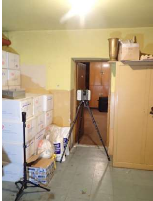
Fotogram nr. 50 – Zdjęcie wykonane w trakcie skaningu laserowego 3D. – Źródło: zdjęcia własne z wizji lokalnej.
