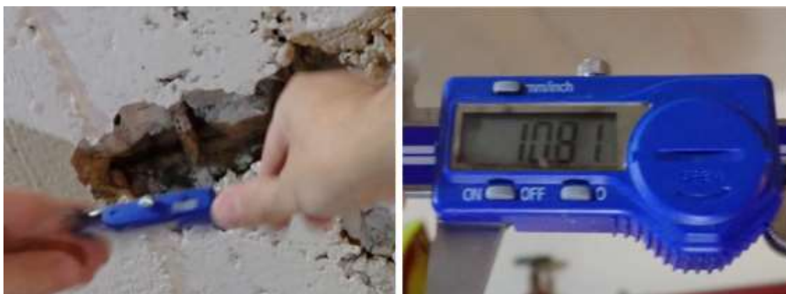
Fotogram nr 41 - Pomiar średnicy pręta. – Źródło: zdjęcia własne z wizji lokalnej.
