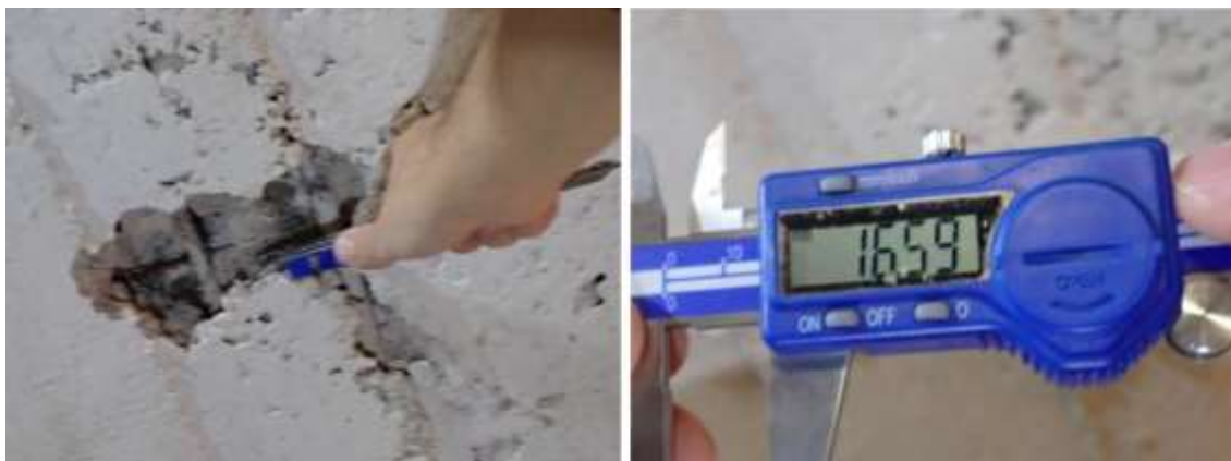
Fotogram nr 40 - Pomiar średnicy pręta. – Źródło: zdjęcia własne z wizji lokalnej.
