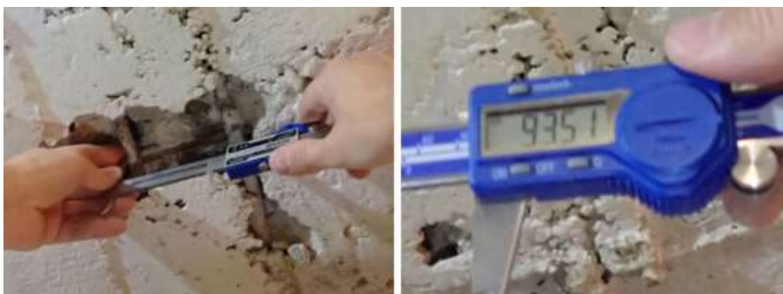
Fotogram nr 42 - Pomiar rozstawu prętów. – Źródło: zdjęcia własne z wizji lokalnej.
